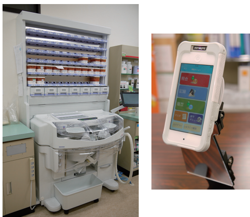
Fig. 4：全自動錠剤散薬分包機（Twin-R93V）とGS-1チェッカーの写真
